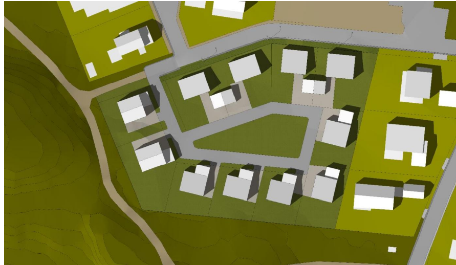
Kuva 17 Toisessa vaihtoehdossa autotie muodostaa lenkin alueen keskelle. Rakennusalojen sijoittelulla pyritään linjakuuteen ja isoihin pihoihin. Ajo pohjoisosan tonteille on mahdollista järjestää joko olemassa olevalta Myötätuulentieltä tai uudelta tieltä.
